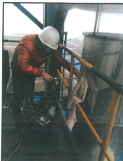
附图 2：水洗吸收废气排气筒采样
