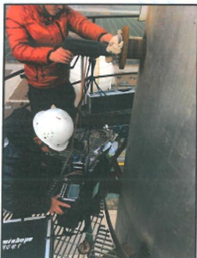
附图 3：预热炉废气排气筒采样
