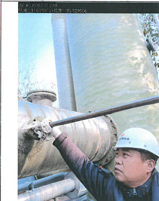
附图 3: (DA058) 三期酚氰废水处理站 2#处理设施前废气采样
